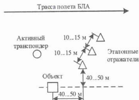
Рис. 2. Схема взаимного расположения объектов на картографируемой сцене
